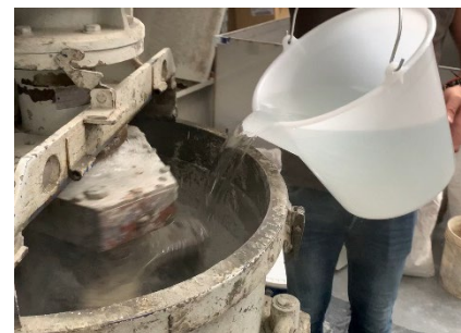
3) Aggiunta di acqua
